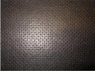
Wer möchte, bestellt eine robuste Bodenplatte, bestehend aus einer stabilen Trägerplatte und einer rutsch- und wasserfesten Siebdruckplatte (dunkelbraun). Die Bodenkonstruktion verfügt über mehrere höhenverstellbare Füße.
